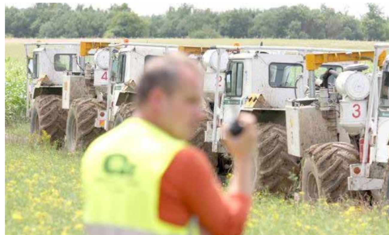
Wibrosejsy (samochody przewożące urządzenia do wzbudzenia fal sejsmicznych).
