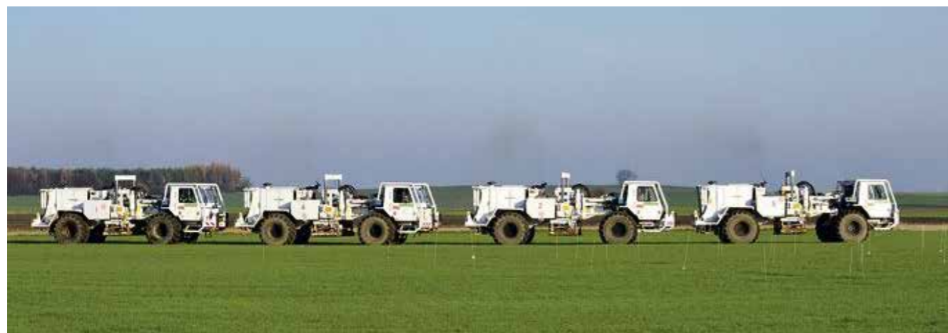
Wibrosejsy (samochody przewożące urządzenia do wzbudzenia fal sejsmicznych). Ciężarówki nazywane wibrosejsami służą do wykonywania badań sejsmicznych. Poruszają się grupami. Korzysta z nich firma Geofizyka z Torunia poszukująca złóż gazu ziemnego.
