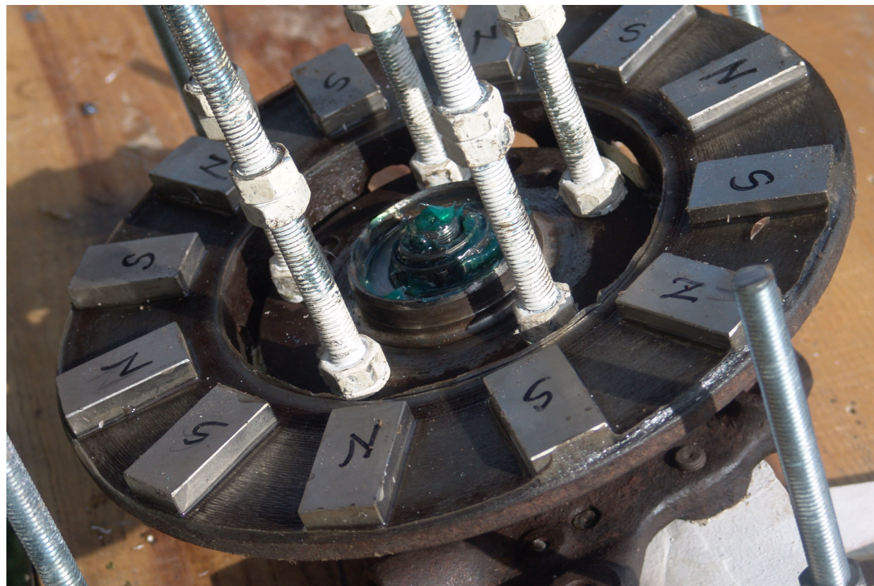
Pierwsza tarcza rotora przykręcona czterema śrubami 12 (w obwodzie wewnętrznym). Druga tarcza rotora będzie zamocowana nad statorem który zostanie zamocowany na czterech skrajnych śrubach. (Stator to 9 cewek połączonych w gwiazdę zalanych żywicą poliestrową. Jego wykonanie pokażę na kolejnych zdjęciach.
