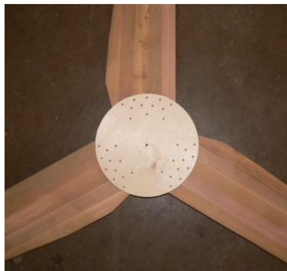
Gotowe śmigło po wstępnym zagruntowaniu gorącym olejem lnianym i farbą podkładową.
