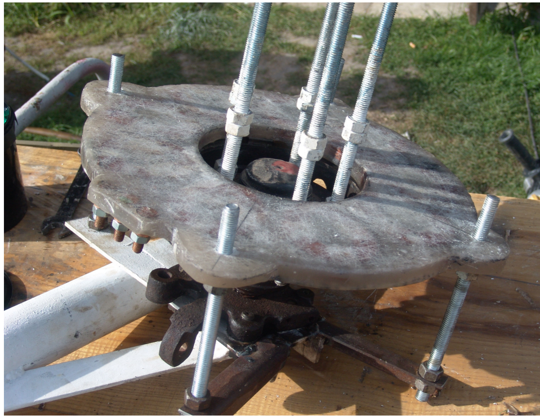
Gotowy stojan (stator) zamocowany na głowicy wiatraka nad pierwszą tarczą wirnika. Założenie drugiego wirnika wymaga ostrożności, ponieważ siła przyciągania magnesów jest tak duża, że może uszkodzić palce u rąk dociskając je do stojana.
