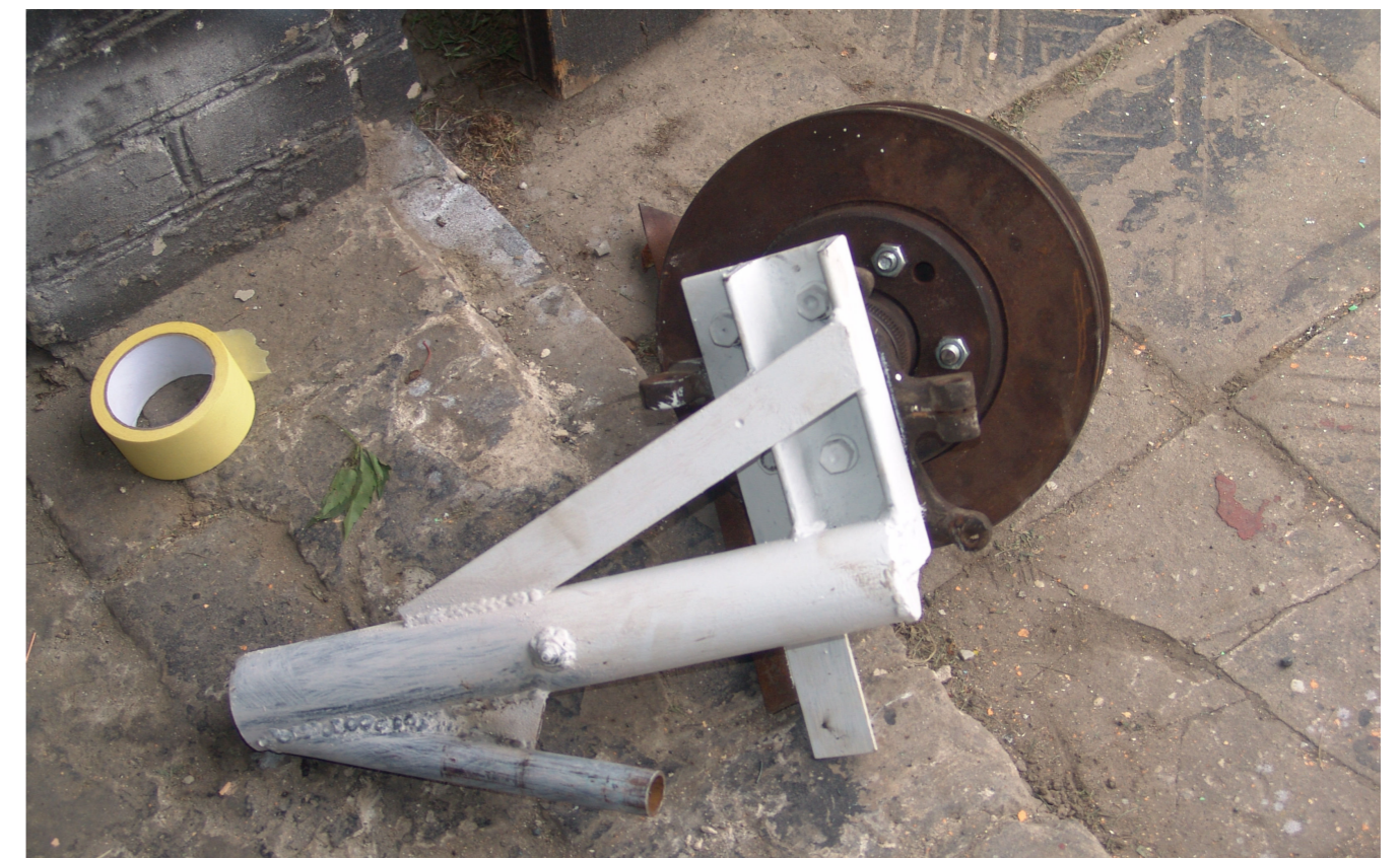
Mocowanie głowicy wiatraka. Piasta i widoczny zawias ogona przyspawany do głowicy pod kątem 45 stop..
