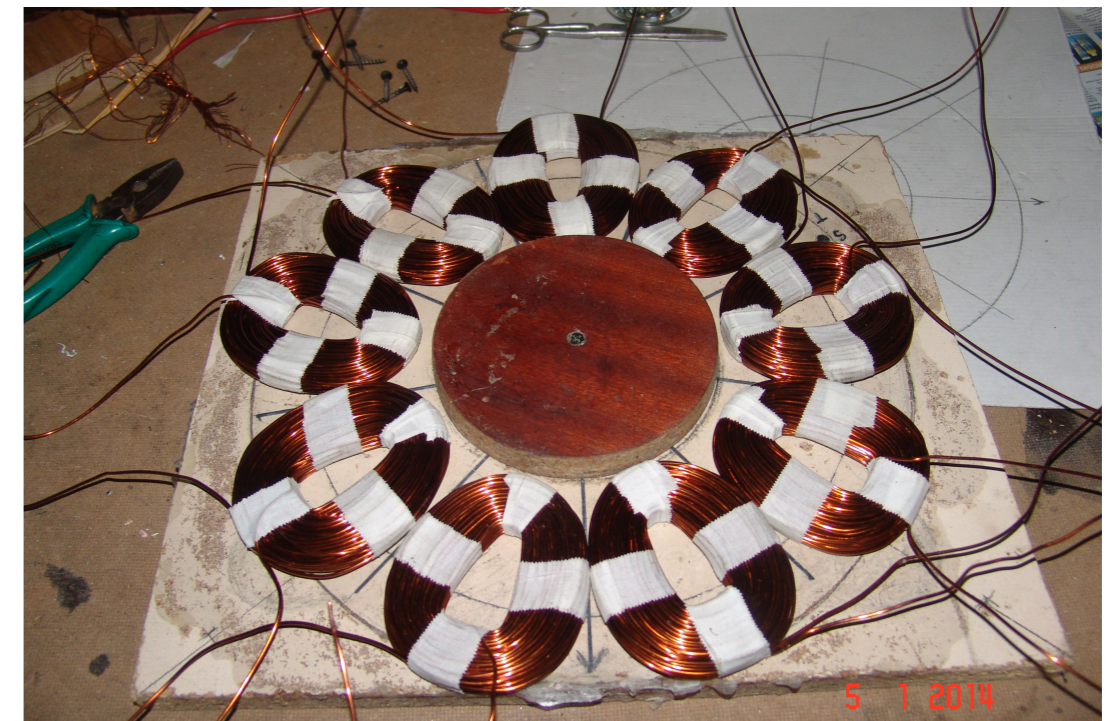
Komplet 9 cewek zabezpieczonych taśmą i ułożonych na dnie formy. Końcówki cewek będą łączone (lutowane) w układ trójfazowy w gwiazdę (można łączyć w trójkąt).
