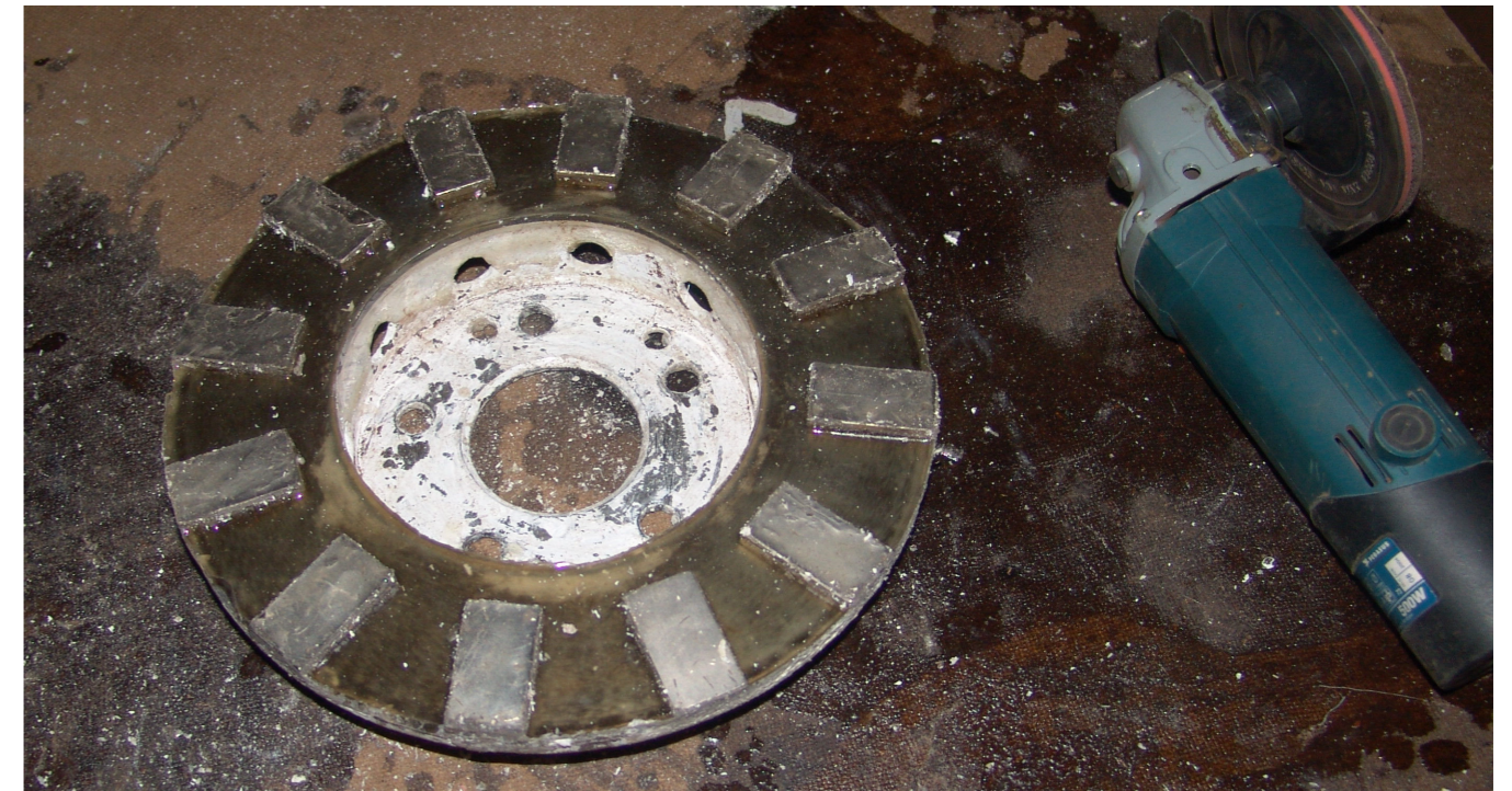
Po wyschnięciu żywicy i usunięciu papierowych taśm, całość czyściłem papierem ściernym szlifierką kontową. Tak przygotowane dwie tarcze z magnesami stanowią gotowy wirnik (rotor) prądnicy - czyli część obrotową. Pomiędzy dwiema tarczami wirnika zostanie zamocowany stojan z dziewięcioma cewkami także zalanymi żywicą jak to pokazałem na kolejnych zdjęciach.
