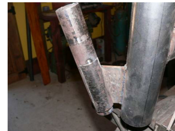
Zawias ogona przyspawany do głowicy wiatraka pod kątem 45 stopni
