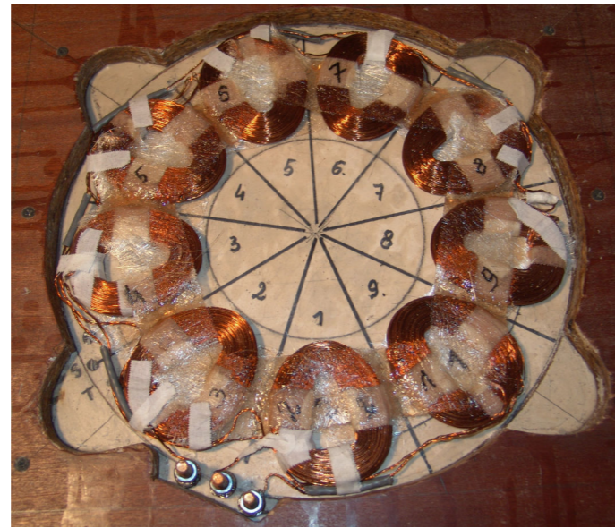
Forma wykonana z płyty wiórowej i komplet 9 cewek połączonych przez lutowanie do zalania żywicą poliestrową wraz miedzianymi trzema śrubami (R,S,T) do zamocowania przewodu odprowadzającego prąd trójfazowy.
