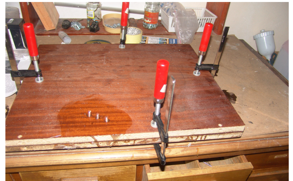
Cewki zalane żywicą poliestrową i szczelnie zamknięte do czasu całkowitego wyschnięcia. Po wyjęciu z formy będzie gotowy stator (stojan) do zamocowania między dwoma rotorami w części mechanicznej wiatraka. Widoczny na kolejnych zdjęciach.
