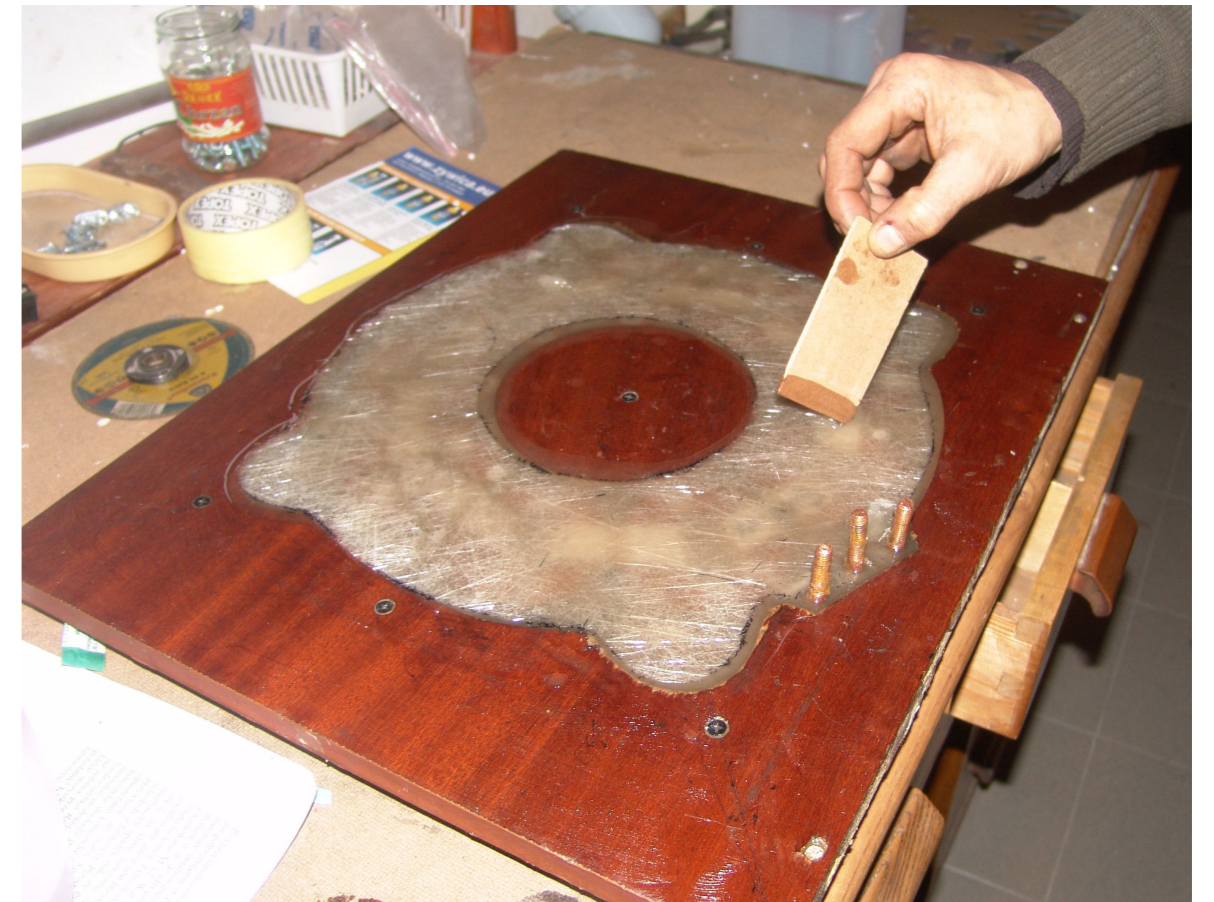
Forma wykonana z płyty wiórowej z kompletem cewek połączonych przez lutowanie zalana żywicą poliestrową wraz miedzianymi trzema śrubami do zamocowania przewodu odprowadzającego prąd trzy fazowy. Po wypełnieniu formy żywicą - na wierzchu zostało zatopione włókno szklane.
