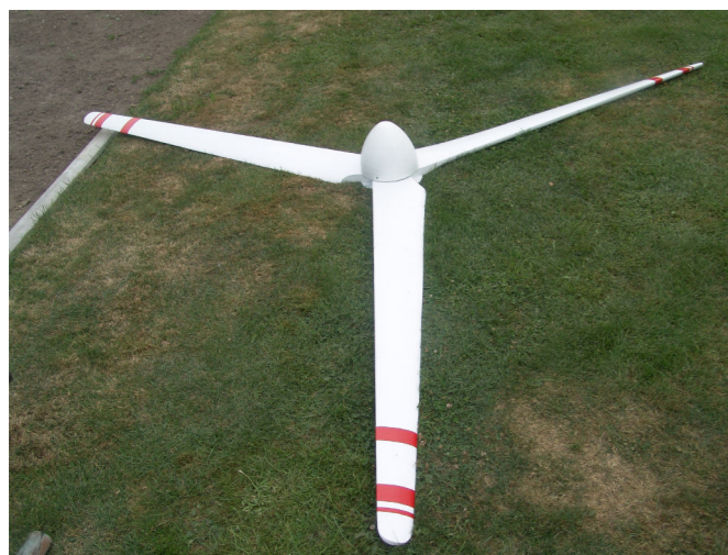
Gotowe śmigło pomalowane ostatecznie. Na środku kołpak z...lampki nocnej.
