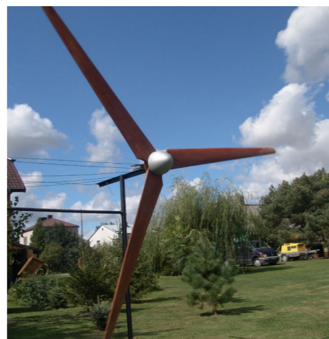
Wyważanie śmigła. Istotna czynność po zakończeniu budowy śmigła to jego wyważenie poprzez dodanie ciężarków np. metalowych podkładek.
