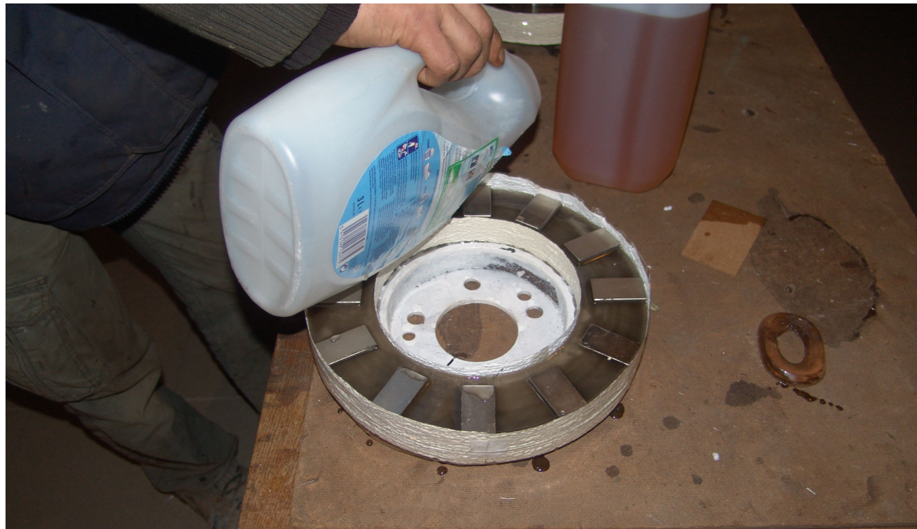
Wypełnianie przestrzeni między magnesami tak aby żywica równomiernie wypełniała wszystkie pola wokół magnesów. Po wyschnięciu żywicy magnesy będą mocno przylegały do tarczy. Dokładne wypełnienie żywicą jest bardzo ważne, ponieważ magnesy przy obciążeniu prądnicy, dużych obrotach i wytwarzanej temperaturze mogą odpaść od metalowego podłoża.
