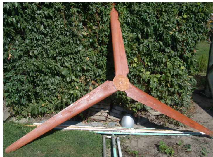
Gotowe śmigło po wstępnym zagruntowaniu gorącym olejem lnianym i farbą podkładową.
